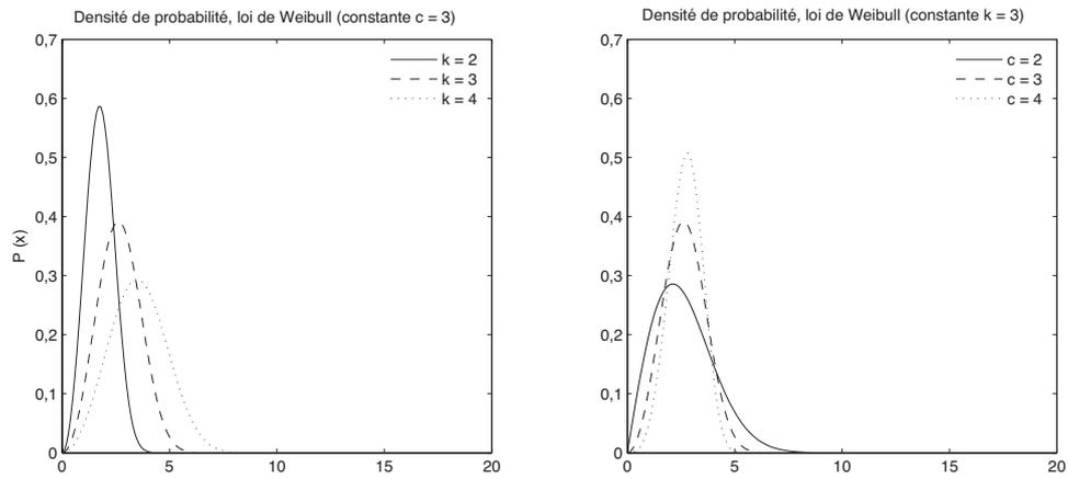
**Figure 4.8. Loi de Weibull: décrit les intervalles de temps qui séparent des phénomènes susceptibles de se produire de façon continue et indépendante, selon une fréquence variable; utilisée pour l'analyse de la vitesse du vent.**
