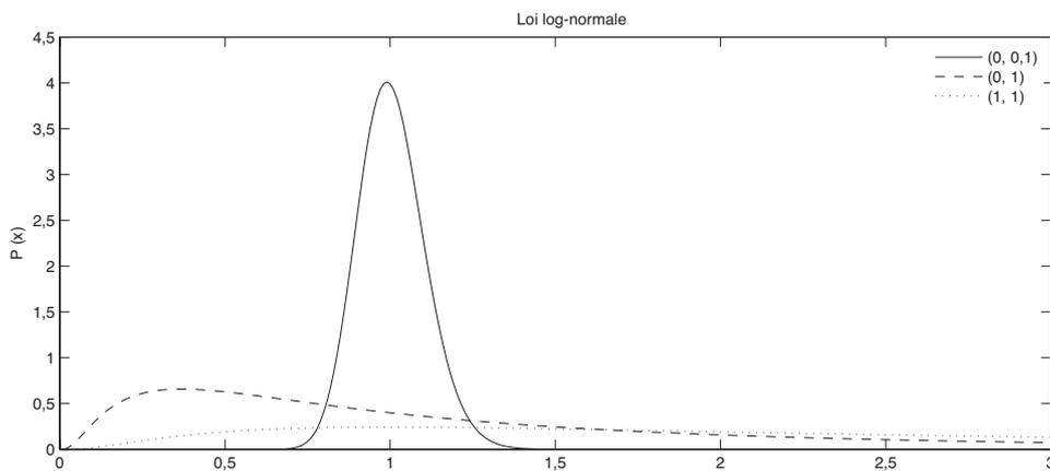
Figure 4.10. Loi log-normale: utilisée quand le logarithme d'une distribution correspond à la loi normale, notamment dans le cas de la distribution des concentrations de particules (pollution de l'air).
