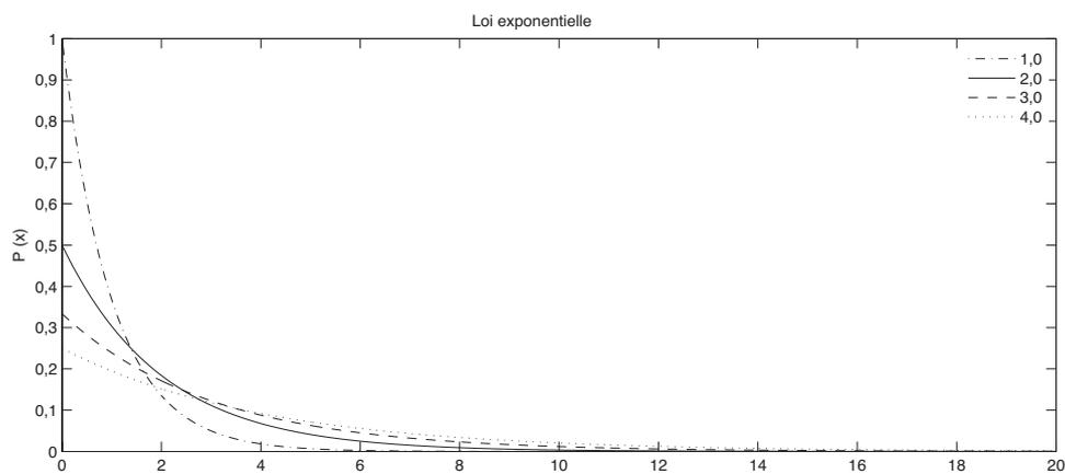
**Figure 4.7. Loi exponentielle: décrit les intervalles de temps qui séparent des phénomènes susceptibles de se produire de façon continue et indépendante, selon une fréquence moyenne constante; utilisée pour l'analyse de la hauteur de précipitation quotidienne.**
