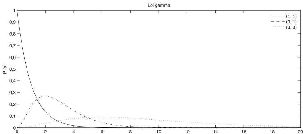
Figure 4.11. Loi gamma: décrit des distributions bornées d'un côté et asymétriques, notamment pour les données de précipitations.
